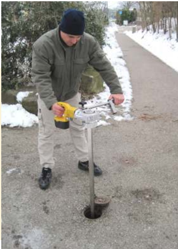
Dreht leichtgängige Armaturen (bis 120 Nm Drehmoment)
