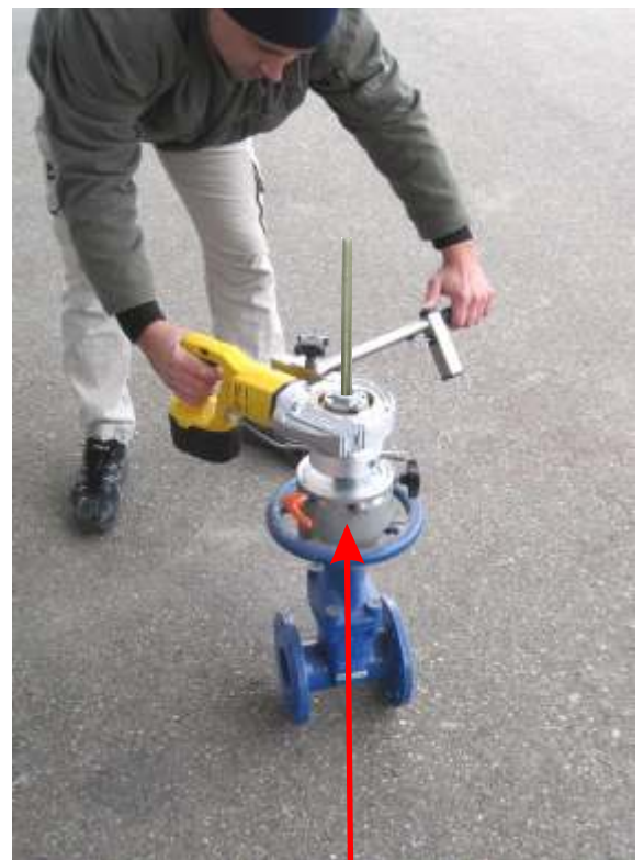
Mit dem Handyfixadapter (optional) können Handradarmaturen (auch mit durchgehender Spindel bis 25 mm Spindeldurchmesser) gedreht werden
