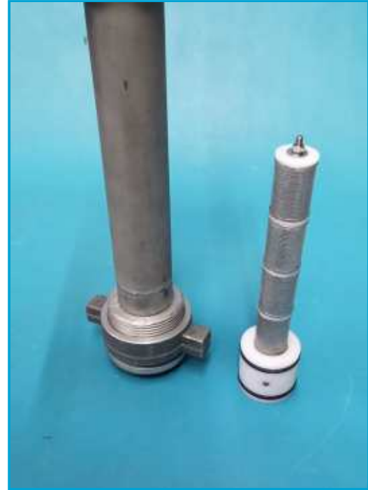
Großflächiges VA-Zylindersieb (statt Flachsieb) mit kleinen Sieblöcher (1 mm Ø) schützt den Systemtrenner und Zähler auch bei feinkörniger Schmutzfracht. Zum Reinigen leicht herausnehmbar
